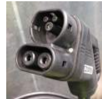
DC egyenáram töltő csatlakozó
